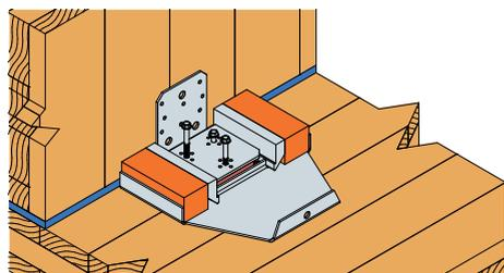
3 Pose des vis spéciales (SDS25600) dans le sol au moyen de l'embout fourni...
