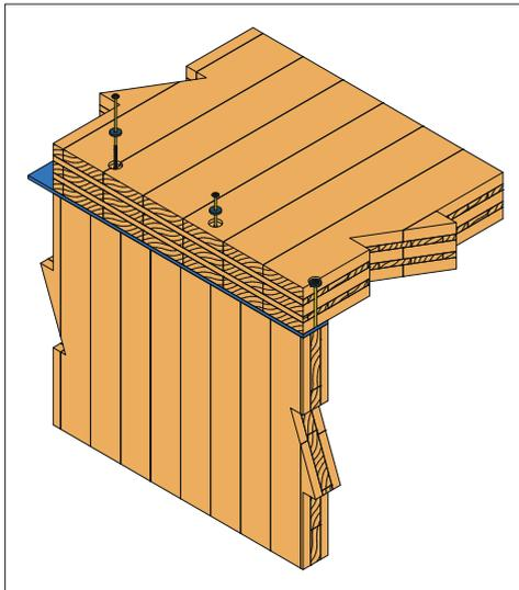
Le premier élément CLT doit être pré-percé pour éviter la transmission de la vibration dans la partie lisse de la vis.
