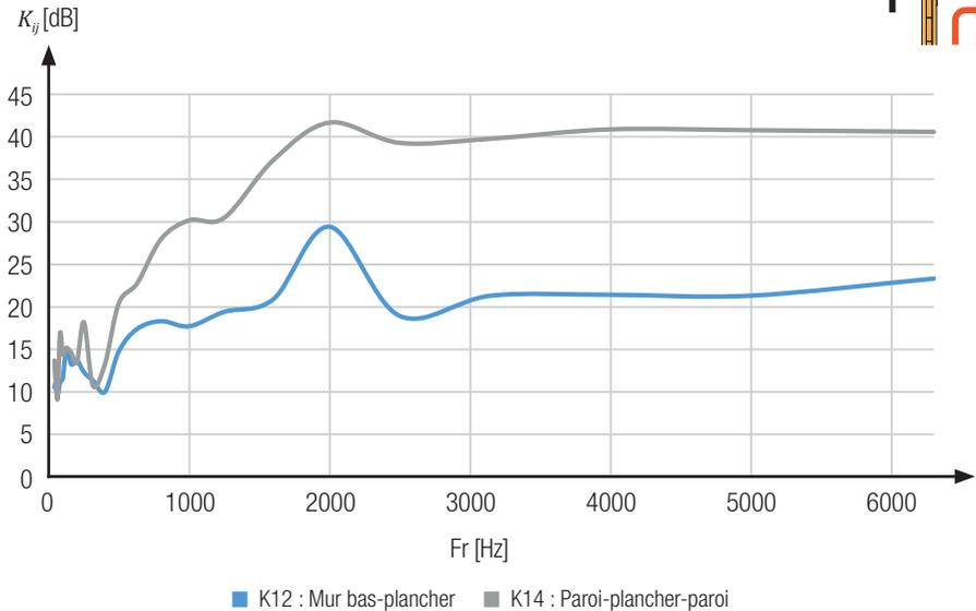
Les résultats obtenus pour la solution ABR255 seule vont servir de base pour l'évaluation acoustique des solutions alternatives proposées dans les pages suivantes. Pour cela, nous introduirons trois grandeurs afin de calculer le gain associé en basses fréquences BF, moyennes fréquences MF et en hautes fréquences HF :
