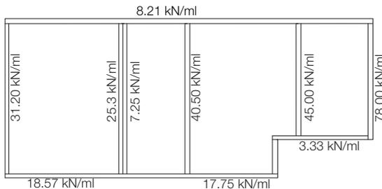
L'exemple s'effectue sur le mur chargé à 17.75 kN/m. Une fois la charge introduite dans le logiciel, on obtient le SIT350/60/12.5, c'est-à-dire une bande de largeur 60 mm et d'épaisseur 12.5 mm.
