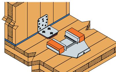
6 Retrait du moule de montage MOABAI vers l'avant et clouage de l'équerre ABAI au mur avec pointes d'ancrage CNA4.0x60.
