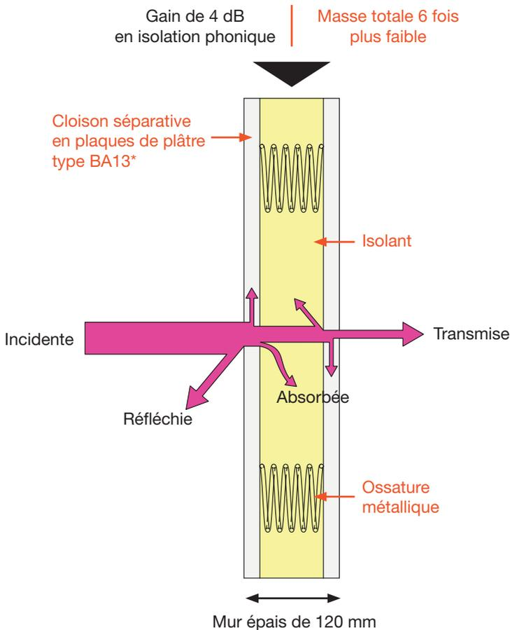
Au contact d'un matériau, l'onde incidente est en partie réfléchiée et absorbée, le reste de l'onde est transmis à la pièce adjacente.
